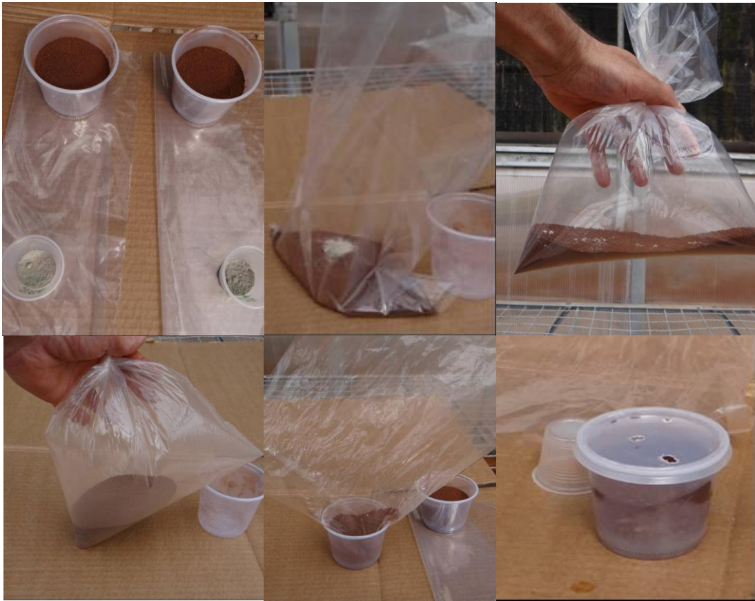
Figura 2. Detalhe do processo de incorporação dos calcários no solo.
