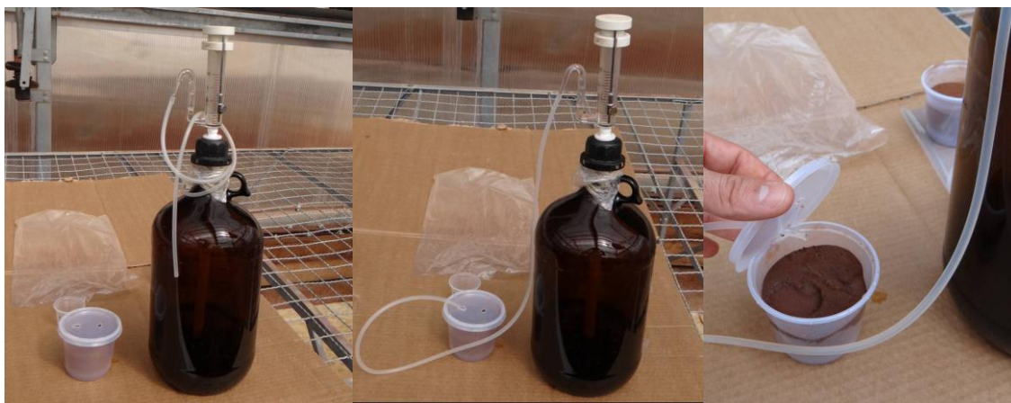
Figura 3. Detalhe do processo de adição de água deionizada nos recipientes.
